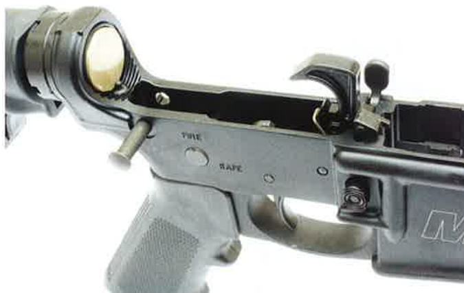
Close-up van de onderkast, met de hamer ontspannen.
