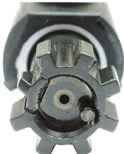
De voorkant van de afsluiter, met de opening voor de slagpin, de patroontrekker links bovenin en de plumjer van de uitwerper.
